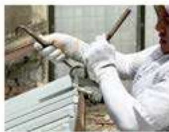
使用板金夾具將90度金屬夾平
